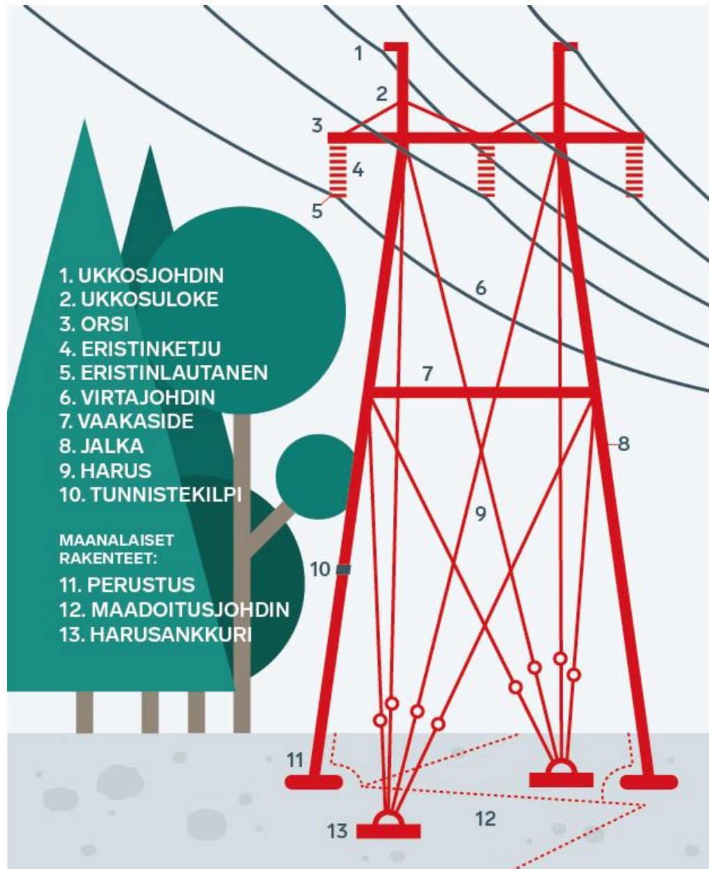
Kuva 6-4. Voimajohdon osat (Fingrid 2022).
